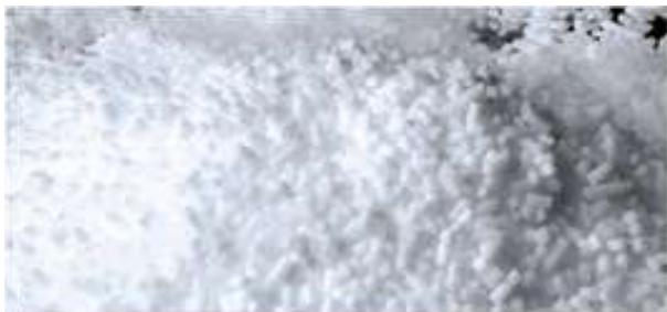
Il ghiaccio secco è anidride carbonica allo stato solido ( $-78,5^{\circ}\text{C}$ ) e viene prodotto partendo dal gas liquefatto in pressione per effetto di una espansione controllata.
